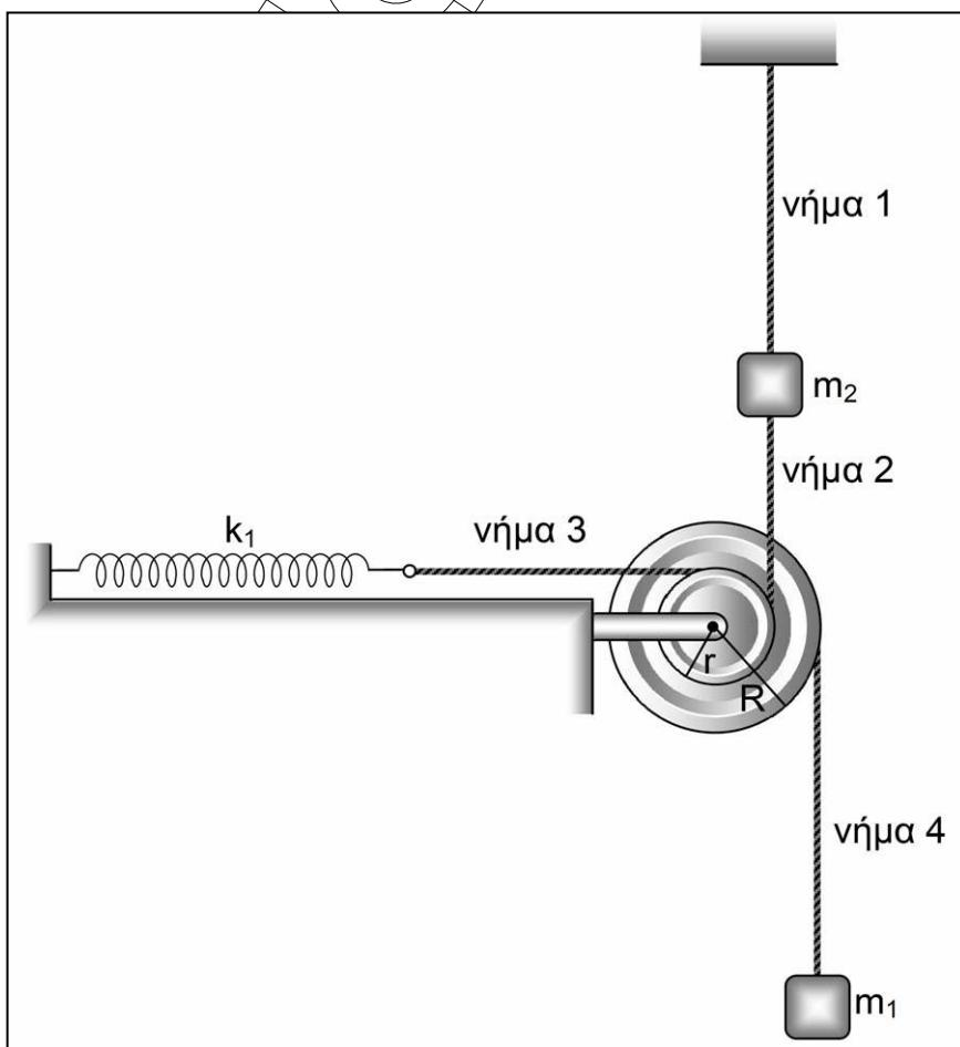
Στο αυλάκι του μεγάλου δίσκου της τροχαλίας έχουμε τυλίξει αβαρές και μη εκτατό νήμα (4), στο ελεύθερο άκρο του οποίου έχουμε δέσει σώμα μάζας  $m_1 = 1\text{kg}$ .
